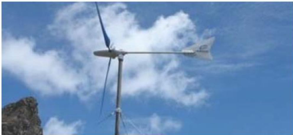
Figura 16 - Turbina eólica pequeno porte (CEPEL, 2010).
