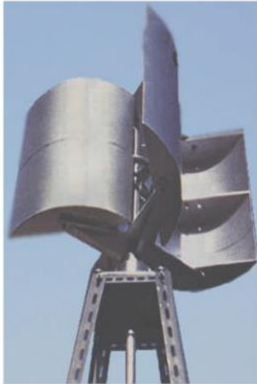
Figura 13 - Turina eólica vertical modelo Savonius (MACHADO, 2014).
